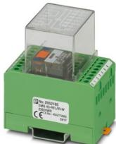
Modulo relè, con relè industriale saldato grandezza 1, contatto: 2 contatti di scambio, per segnalazione collettiva dei guasti, con serie di diodi d'ingresso in polarità P (6 diodi 1N4007) e condensatore parallelo alla bobina e un LED di segnalazione collettiva, tensione d'ingresso 230 V AC
