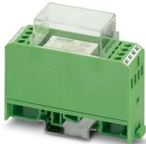
Modulo a relè, con relè saldato, contatto (AgNi): potenze da medie a grandi, 1 contatto di scambio, tensione d'ingresso 24 V AC/DC
