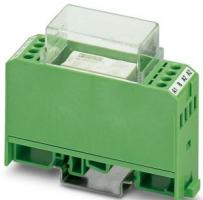
Modulo relè, con mini relè saldato fisso, contatto (AgNi): da medie fino ad alte potenze, 2 contatti deviatori, tensione d'ingresso 230 V AC/DC
