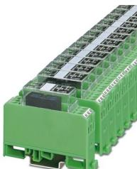
Modulo a relè, con relè saldato, contatto (AgPd60 5 µm dorato a spessore): potenze da medie a grandi, attacco doppio A2, 1 contatto di scambio, tensione d'ingresso 230 V AC/DC
