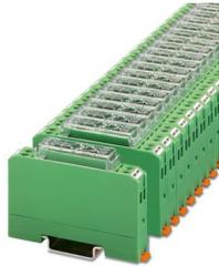
Modulo invertito. Il modulo è preposto alla conversione dei segnali d'uscite transistor NPN in uscite PNP con interruzione del segnale positivo, così come segnali con interruzione PNP in segnali con commutazione NPN con interruzione del segnale negativo (vedere esempio applicativo).
