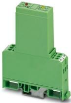
Relè a stato solido di potenza, con LED e protezione nei circuiti di ingresso e uscita, ingresso: TTL 5 V DC, uscita: anticortocircuito, 24 V DC/max. 2 A
