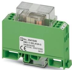
Modulo relè per correnti permanenti elevate, con relè saldato, contatto (AgSnO): Potenze da medie a grandi, 1 contatto in chiusura, tensione d'ingresso 24 V DC, con LED, corrente limite permanente 10 A
