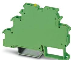
Morsetto a relè a stato solido di potenza, ingresso: 24 V DC, uscita: 3-30 V DC/3 A, spessore morsetti 6,2 mm
