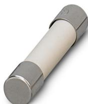
Fusibile d'uscita (5x20 mm), secondo IEC 127-2/EN 60127-2, 2 A rapido
