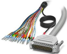
Cavo circolare confezionato schermato; connessione 1: Fili singoli (25-poli) (I conduttori sono siglati e dotati di capocorda. La treccia schermata è prevista su un'estremità separata del cavo.); connessione 2: Connettore maschio D-SUB (1x 25-poli); lunghezza cavo: 2 m
