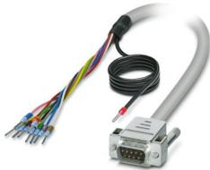
Cavo circolare confezionato schermato; connessione 1: Fili singoli (9-poli) (I conduttori sono siglati e dotati di capocorda. La treccia schermata è prevista su un'estremità separata del cavo.); connessione 2: Connettore maschio D-SUB (1x 9-poli); lunghezza cavo: 2 m
