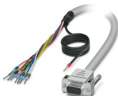
Cavo circolare confezionato schermato; connessione 1: Fili singoli (9-poli) (I conduttori sono siglati e dotati di capocorda. La treccia schermata è prevista su un'estremità separata del cavo.); connessione 2: Connettore femmina D-SUB (1x 9-poli); lunghezza cavo: 4 m
