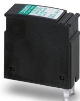
Spine di protezione con circuito di protezione senza correnti di dispersione per due segnali a potenziale di terra zero. Collegamento in serie costituito da varistore e scaricatore di sovratensioni a gas tra i fili di segnali e terra.
