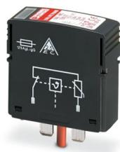
Scaricatore di sovratensioni tipo 2 con varistore per elemento base VAL-MS, controllato termicamente, segnalazione ottica di guasto. Esecuzione: 750 V AC
