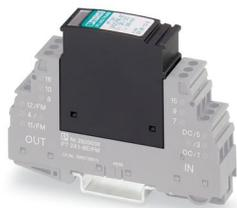
Spina di protezione contro le sovratensioni con indicatore sul modulo e contatto FM per due fili di segnale con potenziale di riferimento comune. Tensione nominale: 24 V DC
