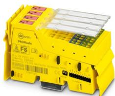
Modulo di uscita digitale legato alla sicurezza, grado di protezione IP20 per sistema SafetyBridge-, INTERBUS-Safety e PROFIsafe. Esso dispone di 4 uscite digitali che in funzione della parametrizzazione, contengono una uscita a commutazione positiva e una negativa.
