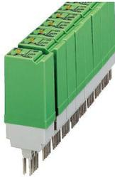
Relè a stato solido di ingresso a innesto, con LED e protezione nei circuiti di ingresso e uscita, ingresso: 48 - 60 V DC, uscita: 8-48 V DC/max. 100 mA, innestabile su morsetti base
