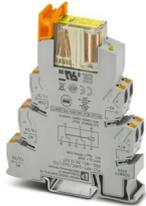
PLC-INTERFACE, composta da base relè e relè di sicurezza a innesto con contatti a carica positiva secondo DIN EN 61810-3, Connessione Push-in, 2 contatti di scambio a conduzione forzata, Diodo di smorzamento, Tensione d'ingresso: 24 V DC
