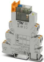
PLC-INTERFACE, composto da base relè e relè a contatto dorati multistrato a innesto con comando manuale, LED di stato integrato, Connessione Push-in, 2 contatti di scambio, Ponte raddrizzatore, Tensione d'ingresso: 24 V AC/DC
