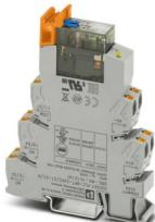
PLC-INTERFACE, composto da base relè e relè a contatto dorati multistrato con comando manuale, LED di stato integrato e diodo di smorzamento, Connessione Push-in, 2 contatti di scambio, Diodo di smorzamento, Tensione d'ingresso: 24 V DC
