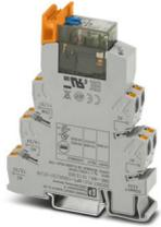
PLC-INTERFACE, composto da base relè e relè a contatto di potenza a innesto con comando manuale, LED di stato integrato, Connessione Push-in, 2 contatti di scambio, Ponte raddrizzatore, Tensione d'ingresso: 120 V AC / 110 V DC
