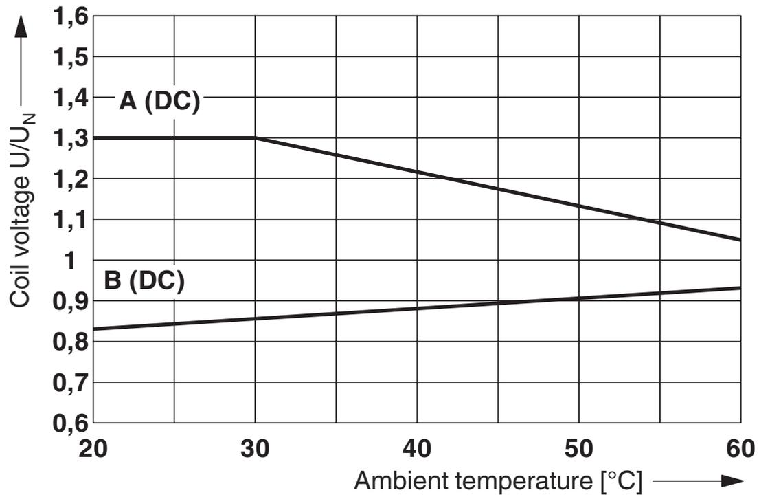
Curva A: massima tensione permanente con corrente limite permanente
