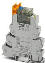
PLC-INTERFACE, composto da base relè e relè a contatto di potenza a innesto con comando manuale, LED di stato integrato, Connessione a vite, 1 contatto di scambio, Ponte raddrizzatore, Tensione d'ingresso: 120 V AC / 110 V DC
