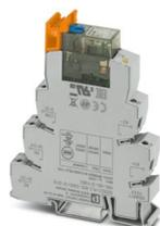
PLC-INTERFACE, composto da base relè e relè a contatto dorati multistrato con comando manuale, LED di stato integrato e diodo di smorzamento, Connessione a vite, 2 contatti di scambio, Diodo di smorzamento, Tensione d'ingresso: 24 V DC
