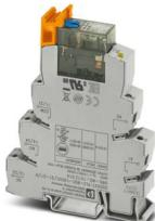
PLC-INTERFACE, composto da base relè e relè a contatto di potenza a innesto con comando manuale, LED di stato integrato, Connessione a vite, 2 contatti di scambio, Ponte raddrizzatore, Tensione d'ingresso: 120 V AC / 110 V DC
