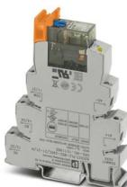
PLC-INTERFACE, composto da base relè e relè a contatto di potenza a innesto con comando manuale, LED di stato integrato e diodo di smorzamento, Connessione a vite, 2 contatti di scambio, Diodo di smorzamento, Tensione d'ingresso: 24 V DC
