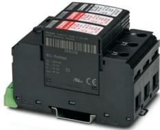
Scaricatore di sovratensione a 3 canali con contatto di segnalazione remota, per 120/240 V AC (configurazione "split-phase"), 3 fili più terra.
