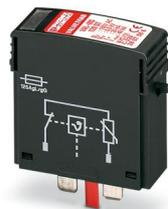
Dispositivo di protezione contro le sovratensioni tipo 1, con riconoscimento UL e connettore di protezione contro le sovratensioni IEC tipo 2 con varistore e dispositivo di sezionamento termico per l'impiego con elementi base VAL-US, segnalazione errori meccanica e ottica
