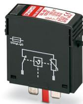
Dispositivo di protezione contro le sovratensioni tipo 1, con riconoscimento UL e connettore di protezione contro le sovratensioni IEC tipo 2 con varistore e dispositivo di sezionamento termico per l'impiego con elementi base VAL-US, segnalazione errori meccanica e ottica
