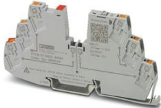
Interruttore di protezione elettronico a un canale per la protezione di utenze da 24 V DC in caso di sovraccarico e cortocircuito. Semplice ripartizione del potenziale con i componenti del sistema di morsetti componibili CLIPLINE complete. Con corrente nominale fissa. Per l'installazione su guide DIN.
