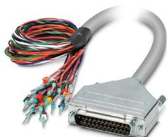
Cavo circolare confezionato schermato; connessione 1: Fili singoli (25-poli) (I conduttori sono siglati e dotati di capocorda.); connessione 2: Connettore maschio D-SUB (1x 25-poli); lunghezza cavo: 3 m
