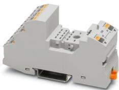
Relè RIF-2 per l'installazione di relè industriali sigillati RTIII con 4 commutatori per l'impiego in Zona 2, connessione Push-in, possibilità d'innesto per moduli d'ingresso/antidisturbo, per il montaggio su NS 35/7,5
