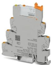
PLC-INTERFACE per funzioni di input, composta da morsetto base PLC-BPT.../SEN con connessione Push-in e relè in miniatura a innesto con contatto in oro multistrato e azionamento manuale, 1 contatto aperto a riposo, tensione di ingresso 24 V DC
