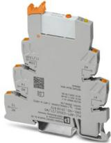
PLC-INTERFACE composta da morsetto base PLC-BPT.../21 con connessione Push-in e relè in miniatura a innesto con contatto di potenza e azionamento manuale, 1 contatto di scambio, tensione di ingresso 230 V AC/220 V DC
