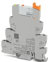
PLC-INTERFACE per funzioni di input, composta da morsetto base PLC-BSC.../SEN con connessione a vite e relè in miniatura a innesto con contatto in oro multistrato e azionamento manuale, 1 contatto aperto a riposo, tensione di ingresso 120 V AC/110 V DC
