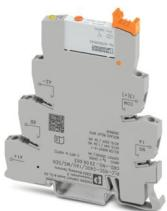
PLC-INTERFACE per funzioni di input, composta da morsetto base PLC-BSC.../SEN con connessione a vite e relè in miniatura a innesto con contatto in oro multistrato e azionamento manuale, 1 contatto aperto a riposo, tensione di ingresso 24 V DC
