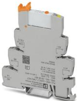
PLC-INTERFACE per funzioni di output, composta da morsetto base PLC-BSC.../ACT con connessione a vite e relè in miniatura a innesto con contatto di potenza e azionamento manuale, 1 contatto aperto a riposo, tensione di ingresso 24 V DC
