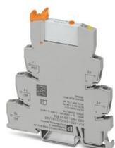
PLC-INTERFACE, composta da morsetto base PLC-BSC.../21 con connessione a vite e relè in miniatura a innesto con contatto in oro multistrato e azionamento manuale, 1 contatto di scambio, tensione di ingresso 24 V AC/DC
