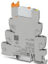
PLC-INTERFACE, composta da morsetto base PLC-BSC.../21 con connessione a vite e relè in miniatura a innesto con contatto di potenza e azionamento manuale, 1 contatto di scambio, tensione di ingresso 125 V DC
