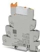
PLC-INTERFACE, composta da morsetto base PLC-BSC.../21 con connessione a vite e relè in miniatura a innesto con contatto di potenza e azionamento manuale, 1 contatto di scambio, tensione di ingresso 24 V DC
