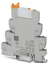
PLC-INTERFACE, composta da morsetto base PLC-BSC.../21 con connessione a vite e relè in miniatura a innesto con contatto di potenza e azionamento manuale, 1 contatto di scambio, tensione di ingresso 12 V DC
