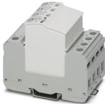
Scaricatore di sovratensioni ad innesto, secondo tipo 2/Classe II, per reti di alimentazione trifase con N e PE separato (sistema a 5 conduttori: L1, L2, L3, N, PE). Con una capacità di dispersione di 40 kA sugli SPD nel punto di alimentazione dell'impianto conforme ai requisiti della norma VDE 0100-534:2016-10.
