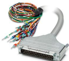
Cavo circolare confezionato schermato; connessione 1: Fili singoli (37-poli) (I conduttori sono siglati e dotati di capocorda.); connessione 2: Connettore maschio D-SUB (1x 37-poli); lunghezza cavo: 15 m
