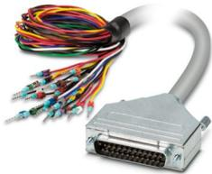
Cavo circolare confezionato schermato; connessione 1: Twisted pair (25-poli) (I conduttori sono siglati e dotati di capicorda.); connessione 2: Connettore maschio D-SUB (1x 25-poli); lunghezza cavo: 5 m
