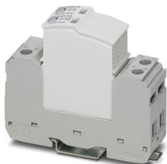
Scaricatore di sovratensioni ad innesto senza corrente di dispersione secondo tipo 2 / Classe II, per reti di alimentazione monofase con N e PE separati (sistema a 3 conduttori: L1, N, PE), con contatto FM.
