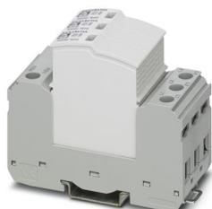
Scaricatore di sovratensioni ad innesto senza corrente di dispersione secondo tipo 2 / Classe II, per reti di alimentazione trifase con PE e N posati insieme in un conduttore (sistema a 4 conduttori: L1, L2, L3, PEN), con contatto FM.
