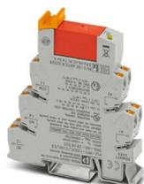
PLC-INTERFACE, composta da morsetto base montabile su guida da 14 mm con connessione Push-in e relè a innesto con contatto di potenza 10 A, 1 contatto di scambio, tensione di ingresso 120 V AC/110 V DC. Omologata secondo ATEX/IECEX (zona 2) e zona Ex Class I, Div. 2.
