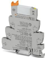
PLC-INTERFACE, composta da morsetto base montabile su guida da 6,2 mm con connessione a vite e relè in miniatura a innesto con contatto di potenza 6 A, 1 contatto di scambio, tensione di ingresso 120 V AC/110 V DC. Omologata secondo ATEX/IECEX (zona 2) e zona Ex Class I, Div. 2.
