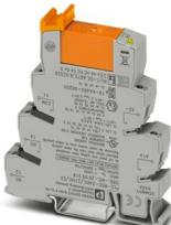
PLC-INTERFACE, composta da morsetto base montabile su guida da 14 mm con connessione a vite e relè a innesto con contatto di potenza 10 A, 1 contatto di scambio, tensione di ingresso 24 V DC. Omologata secondo ATEX/IECEx (zona 2) e zona Ex Class I, Div. 2.
