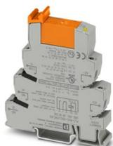
PLC-INTERFACE, composta da morsetto base montabile su guida da 14 mm con connessione a vite e relè a innesto con contatto di potenza 10 A, 1 contatto di scambio, tensione di ingresso 12 V DC. Omologata secondo ATEX/IECEEx (zona 2) e zona Ex Class I, Div. 2.
